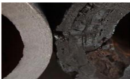
Сталь 12Х1МФ до и после окисления
